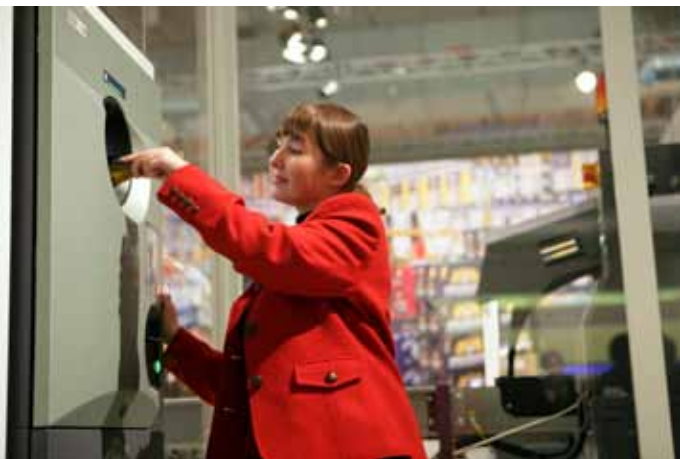
Automat na zálohovanie nápojových obalov, zdroj: http://www.wincor-nixdorf.com
