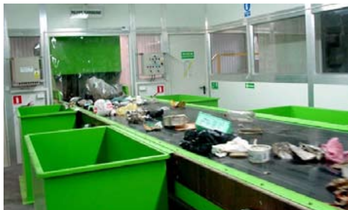
Kabína na manuálne dotriedkovanie zmesového odpadu (zdroj: http://www.etan.com.sg )
