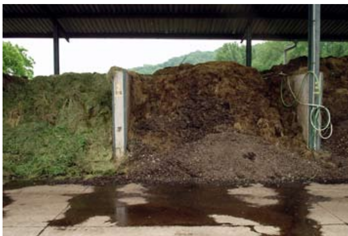
Zastrešené boxy s nútenou aeráciou
