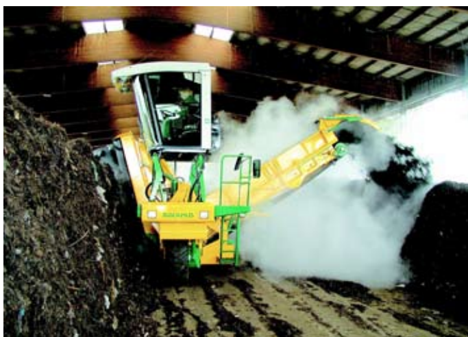
Kompostovanie v hale na hromadách, ktoré sa prekopávajú frézovým prekopávačom
