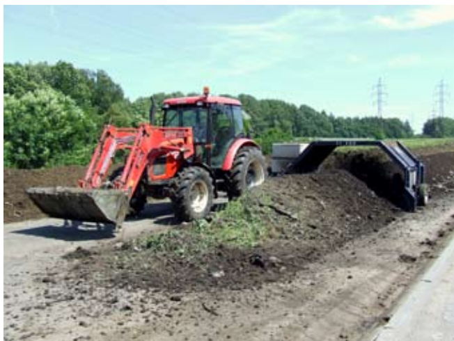
Prekopávanie kompostu zabezpečuje prevzdušnenie a homogenizáciu v pásových hromadách
